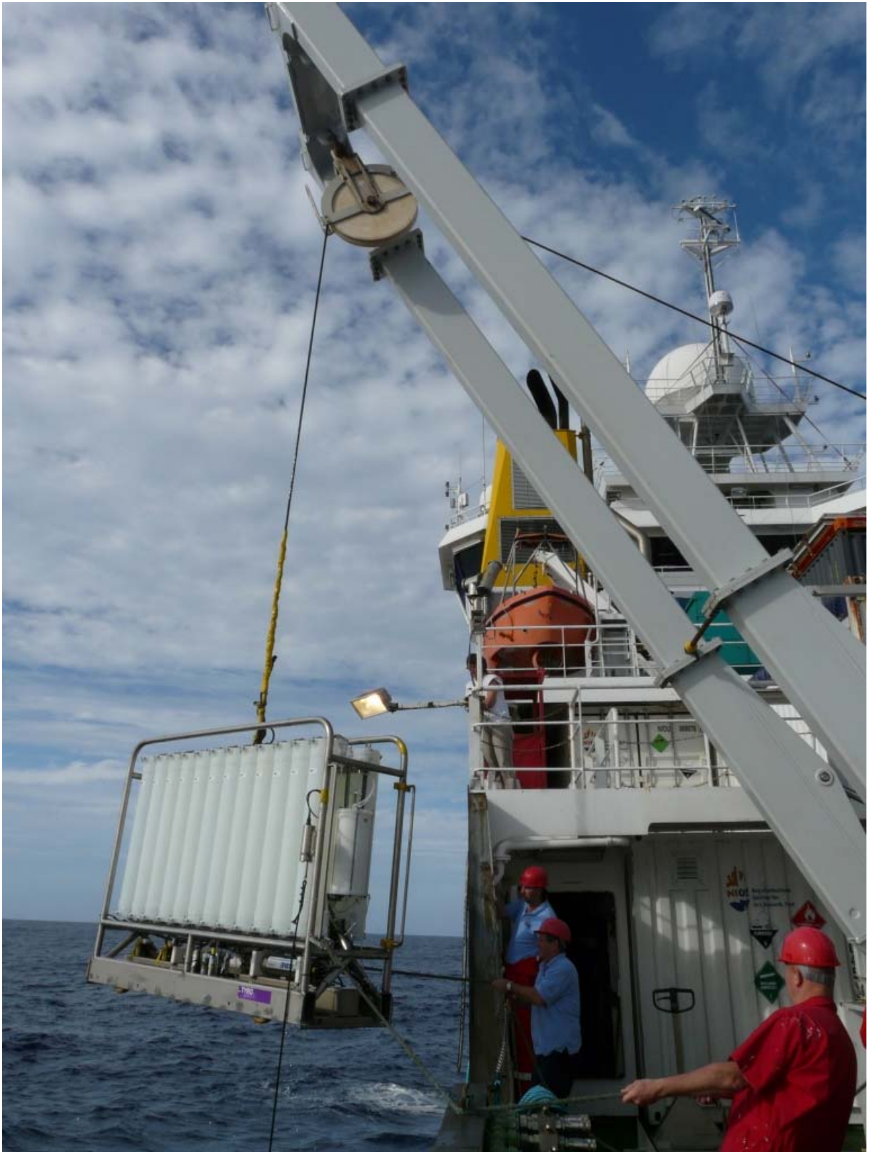
Bijlschrift foto: In de Zuid Atlantische Oceaan assisteren bemanningsleden van het Britse onderzoeksschip RRS James Cook de wetenschappers van het NIOZ met het binnenhalen van de zeewatermonsters. Het titanium frame met de PRISTINE® monsterflessen van kunststof zijn speciaal hiervoor door het NIOZ ontworpen en gebouwd om heel schoon, zonder onbedoelde metaalcontaminatie, monsters te kunnen nemen.
