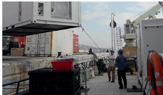
Laboratoriecontainer hejses ombord på R/V Knorr. Containeren er udstyret med filtre og sættes indvendigt under tryk, så partikler ikke trænger ind og forurener prøverne.
